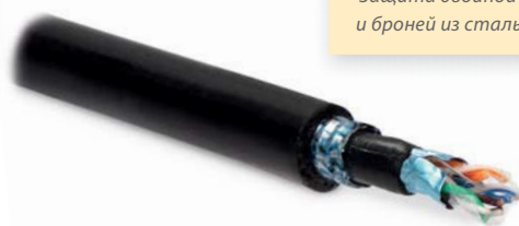
Витая пара solid Защитная пленка Экран-фольга Дренажный провод Внутренняя оболочка Броня Внешняя оболочка
