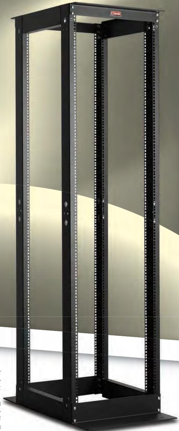
Бескорпусные стойки серии DYNAframe для сетевого оборудования с L-образной крепежной опорой, имеющей физические размеры 19" ш:530мм и г:670/870/1070мм, и 5 вариантами высоты дают потребителям широкий выбор. Соединительные элементы между рамами заменяются для получения вариантов глубины Г:670/870/1070мм, что дает возможность использовать принадлежности, которые используются для стандартных шкафов.
