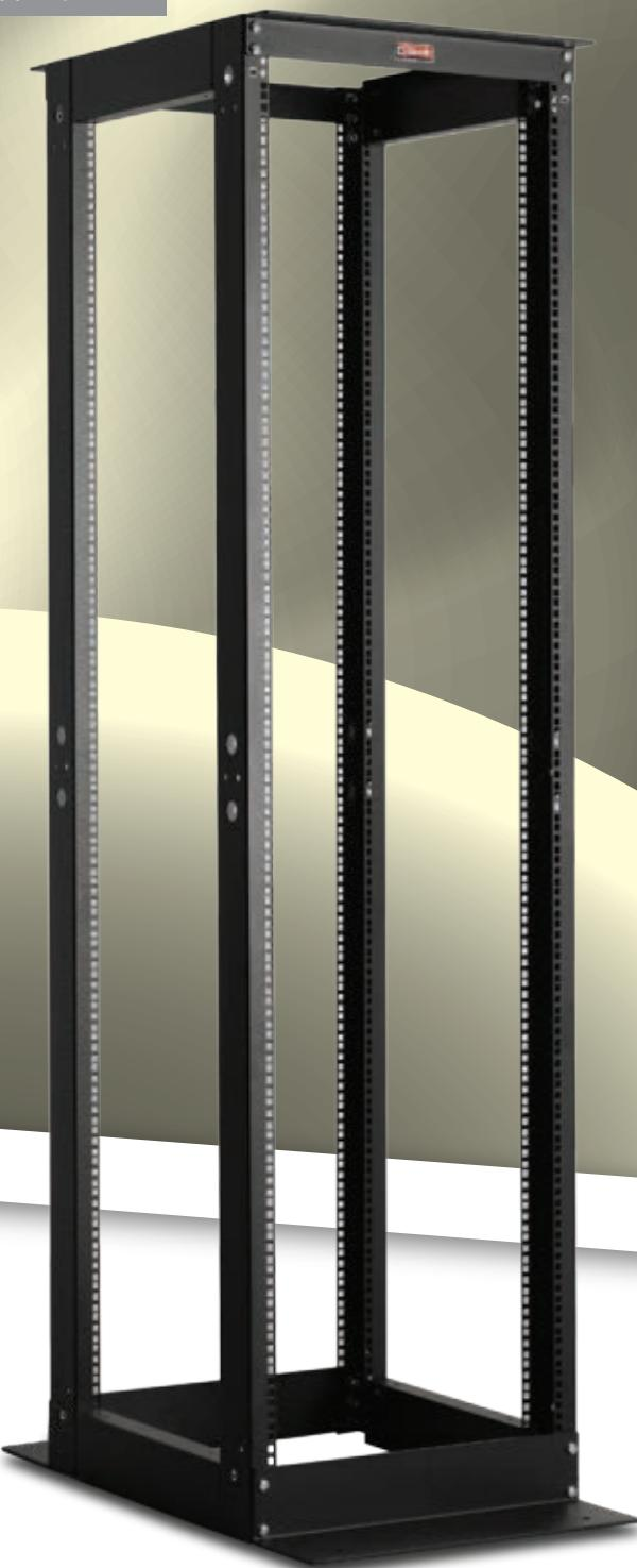
Бескорпусные стойки серии DYNAtframe для сетевого оборудования с L-образной крепежной опорой, имеющей физические размеры 19" ш:530мм и г:670/870/1070мм, и 5 вариантами высоты дают потребителям широкий выбор. Соединительные элементы между рамами заменяются для получения вариантов глубины Г:670/870/1070мм, что дает возможность использовать принадлежности, которые используются для стандартных шкафов.
